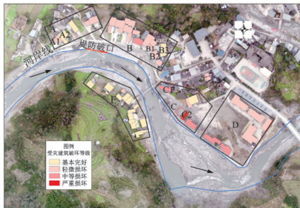
图3 三江镇街村建筑受灾情况
